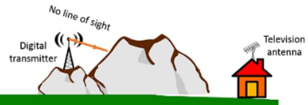
Obstrucciones entre una antena de televisión y la línea de visión del bloque de la torre de transmisión, que conducen a una recepción deficiente o nula.
